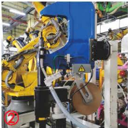
车身部件的锁铆 铆接装配。 铆钉自动上料。
