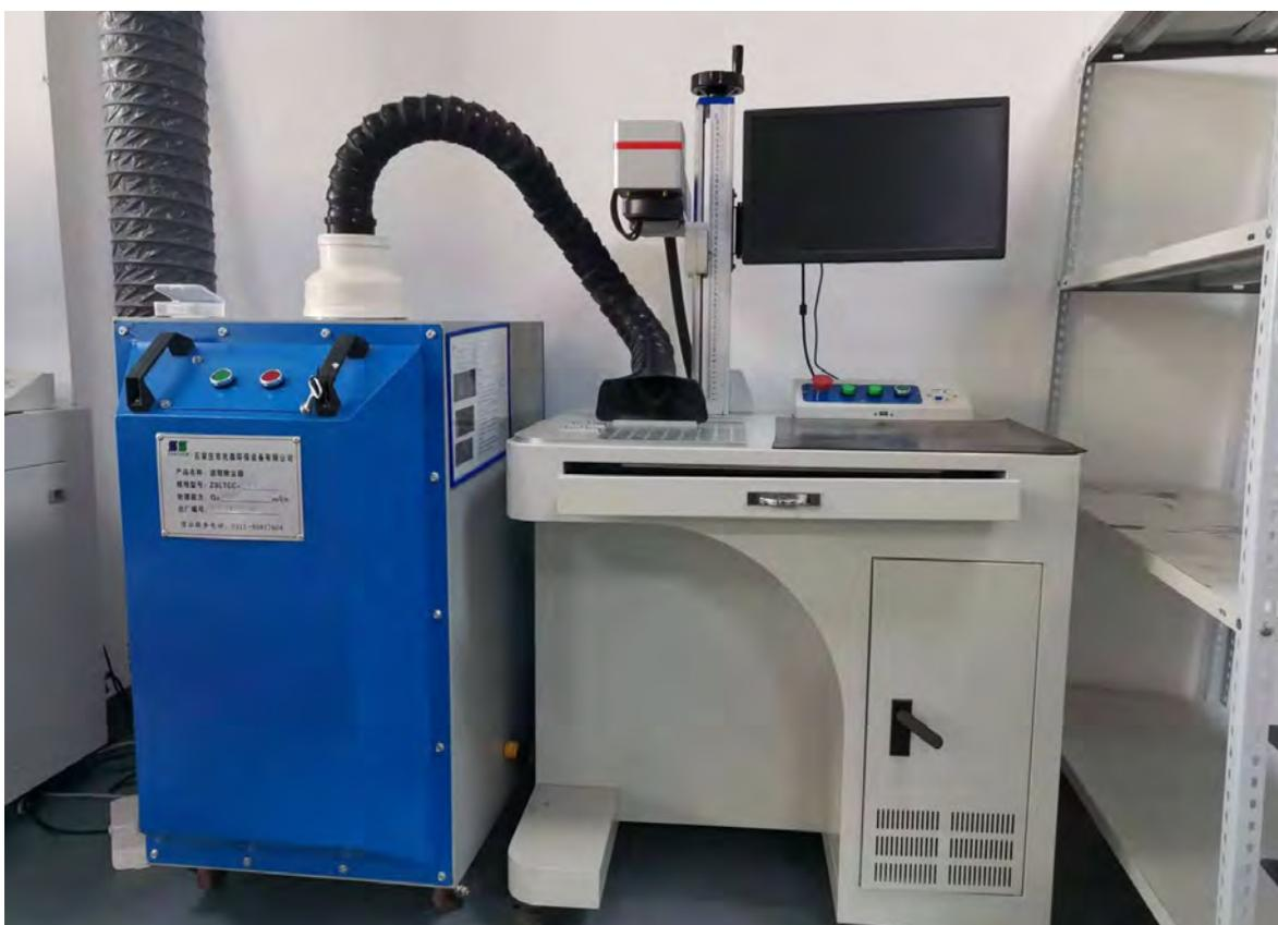
激光打标及滤筒除尘器
