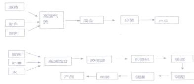
原辅料通过反应釜搅拌混合，砂磨处理，取样检验合格通过磁力泵管道抽入储罐，进行自动分装，成品检验合格入库。
