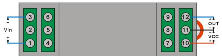
注: 1、3 位端子为输入端子; 11、12 位端子为输出端子; 10、11 端子为电源端子。11 位端子为输出地与电源地共地端; 2、4-9 位端子为空脚, 无须接线。
