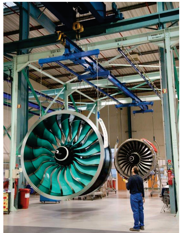
Fig. 3 — UltraFan Demonstrator CTi fan blades and casing.
