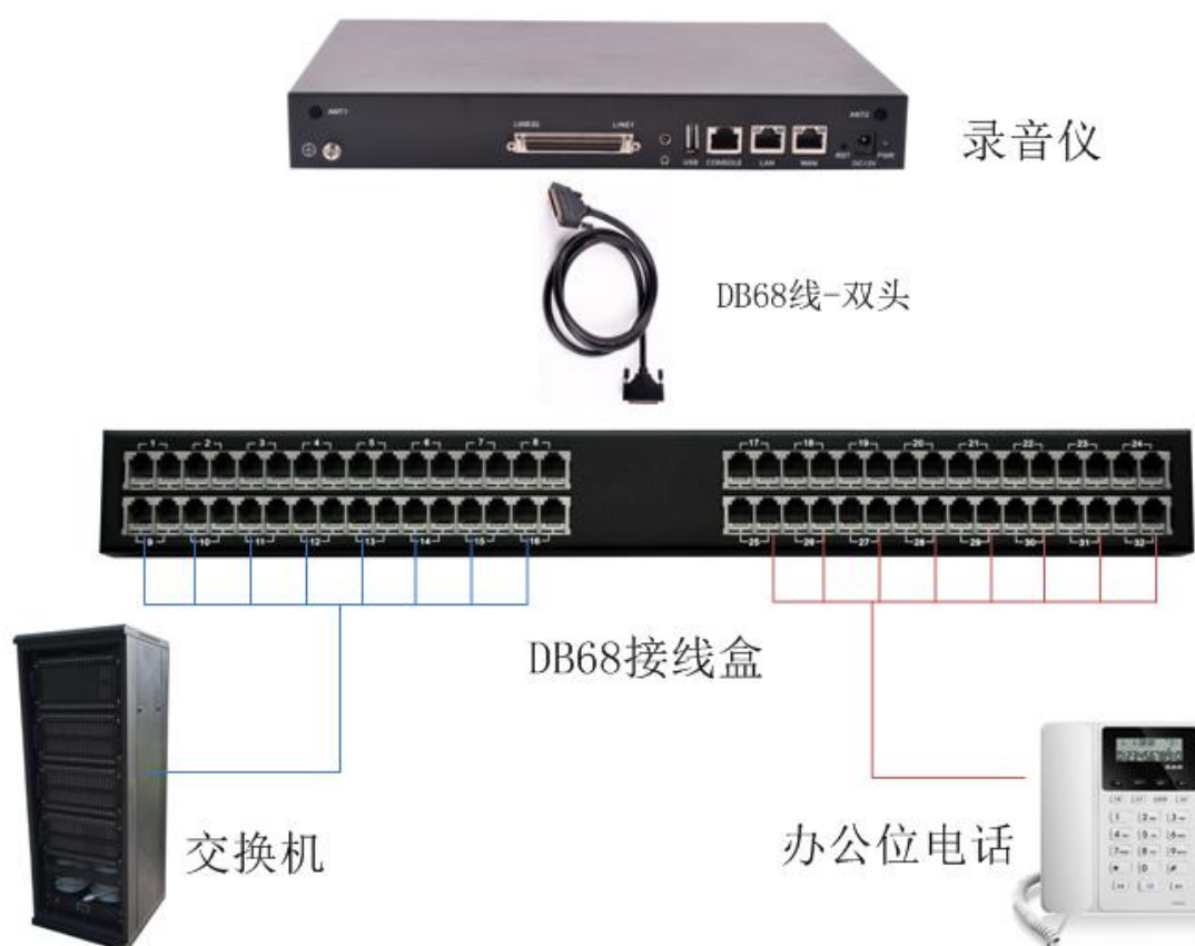
图 1 DB68 接线盒接线图
