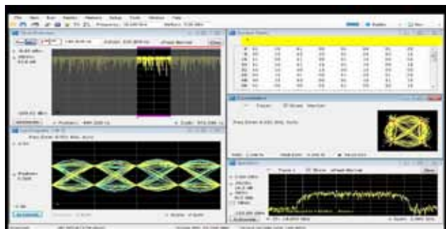
图 20. 载波 18GHz，符号速率 1G 校准后的宽带通信测试结果
