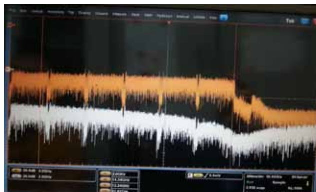
图 31. OFDM 信号校准前后频谱对比图
