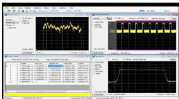
图 14. AWG+ 上变频器产生 25GHz 载波, 带宽 2GHz 的未校准的雷达信号
