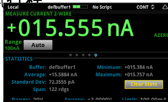
测量的手表待机电流及统计结果、电流的趋势图
