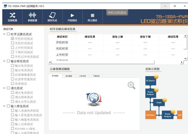
软件界面简单明了，遵从从左到右的逻辑，首先开始测量之前，进行仪器的配置，确定系统中需要的各种仪器是否连接正常。第二步进行参数设定，用户可以设定测试项目的限值，方便进行实测中比对。第三步进行测试项目勾选，将需要测试的项目勾选，然后开始测试，测试结果以数据及测试图形形式显示，可将数据存储于 PC 硬盘中，用于非测试时在软件环境下进行深入分析。第四步将测试结果自动生成报告，数据是 Excel 方便后续进行数据的处理。另外，客户根据不同的测试产品可以保存系统的配置，后续进行同型号的测试可以直接调用配置，节省设定时间，保持前后测试条件一致。
