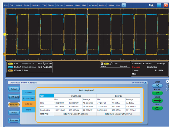
MSO5000B 示波器测量的开关损耗和传导损耗。
