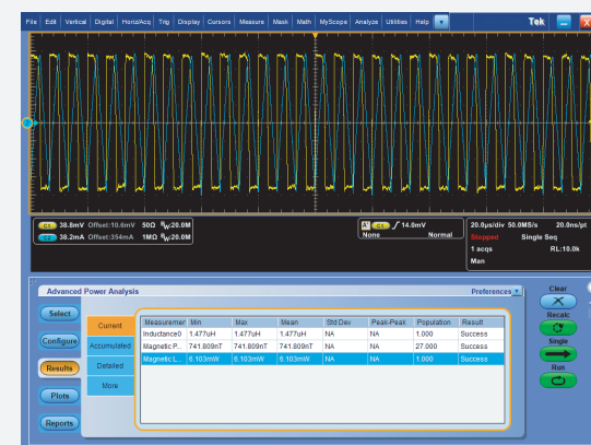
MSO5000B 示波器测量的磁性损耗
