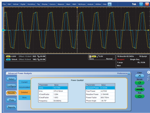
在 MSO5000B 示波器上使用 DPOPWR 分析 AC 功率
