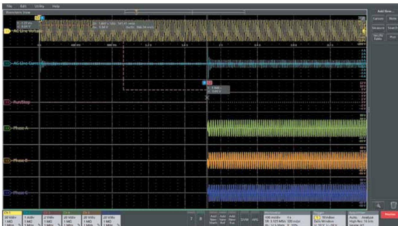
连接 AC 市电后测量三相马达驱动器开机延迟
