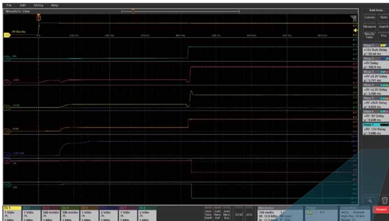
产品中七个稳压电源的开机定时
