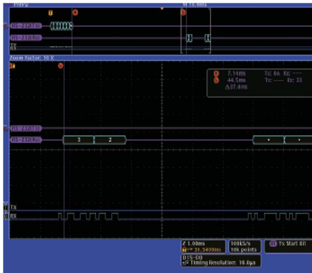
图 16. 测量两条 RS-232 总线上的消息时延。
