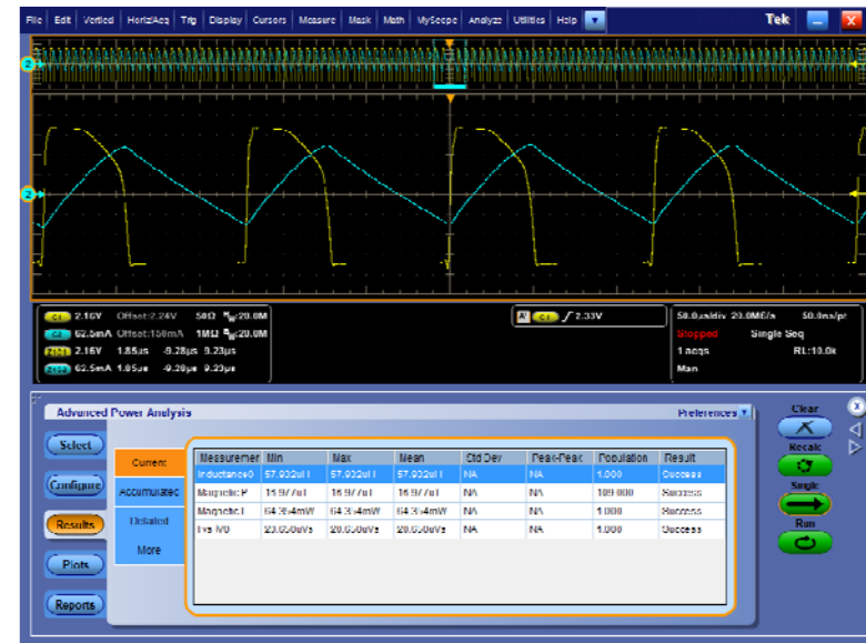
DPOPOPWR 电路磁损耗测试
