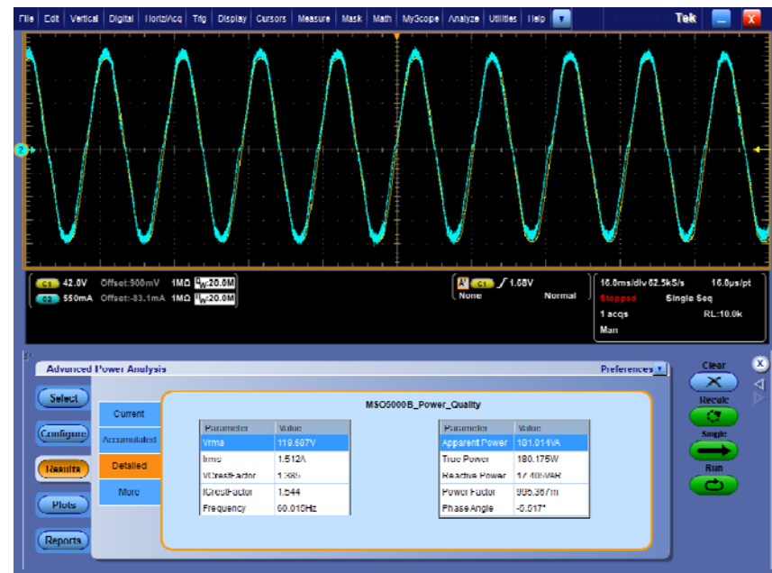
MSO5000B 输入功率质量测试
