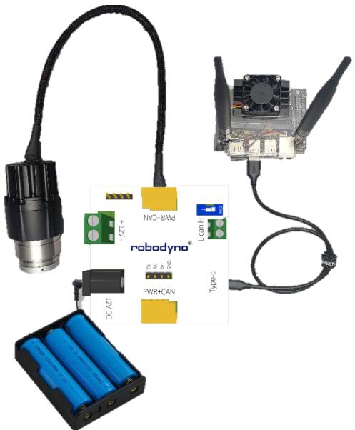
除此之外，也可以选择从电机调试板的 CAN 端子座接入其他 CAN 总线控制设备。
