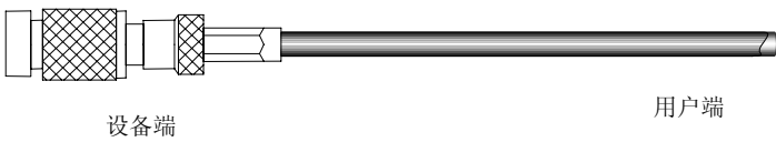
图 3.3-3 75Ω 2M 单股同轴电缆示意图
