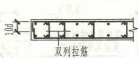
B 端部无暗柱时剪力墙水平钢筋端部做法(二)
