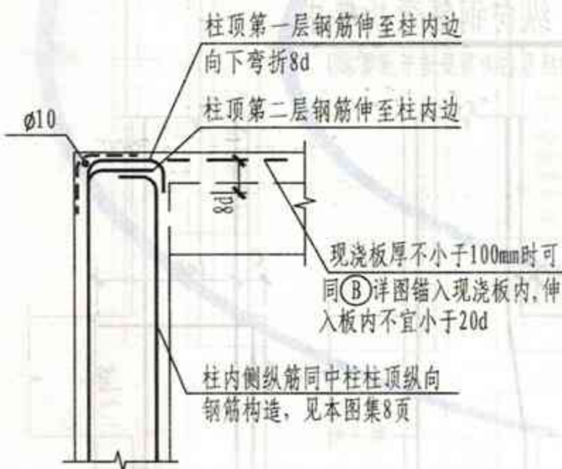
D (用于柱出梁宽范围的外侧纵向钢筋锚固)
