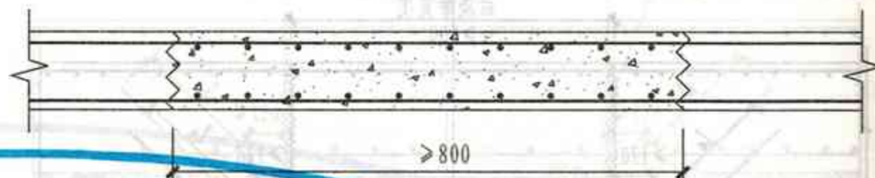
墙后浇带HJD贯通留筋钢筋构造
