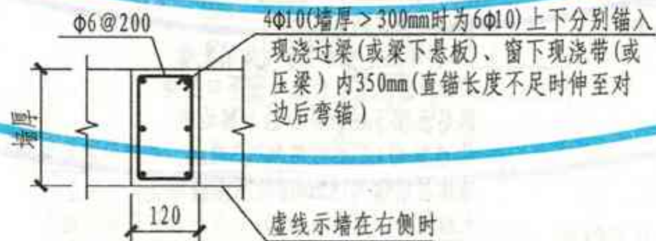
砌体填充外墙拉结构件立面示意图 及现浇带、抱框柱详图
