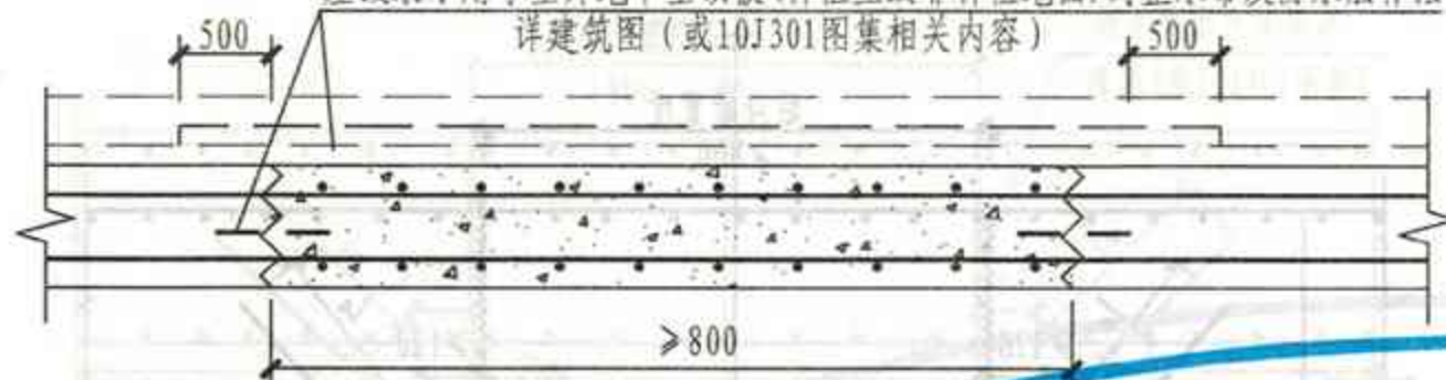
板(及室外地下室顶板)后浇带HJD贯通留筋钢筋构造
