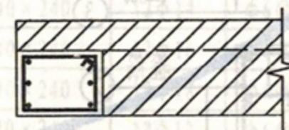
6根纵筋时钢筋位置示意
