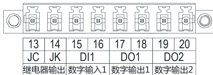
图 37 I/O 端子定义
