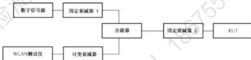
图 6 接收机相邻信道抑制比测试连接图
