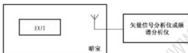
图 3 物理层辐射杂散测试连接图
