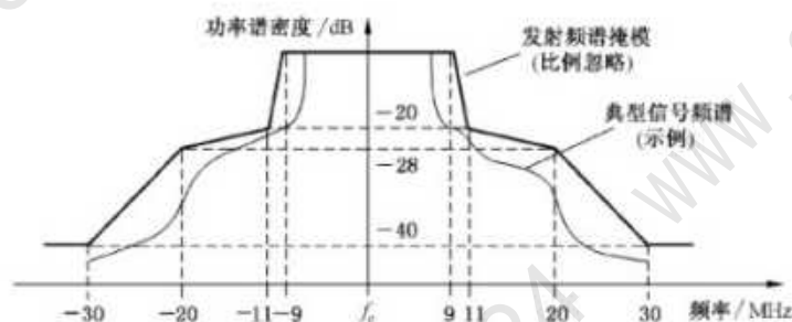
图 9 2.4 GHz 频段发射频谱掩模
