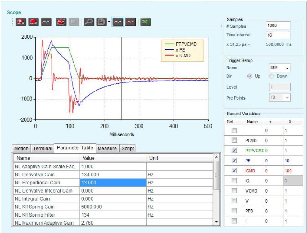
图 12-7. KNLD 134 Hz (ICMD 的数值已放大 100 倍)
