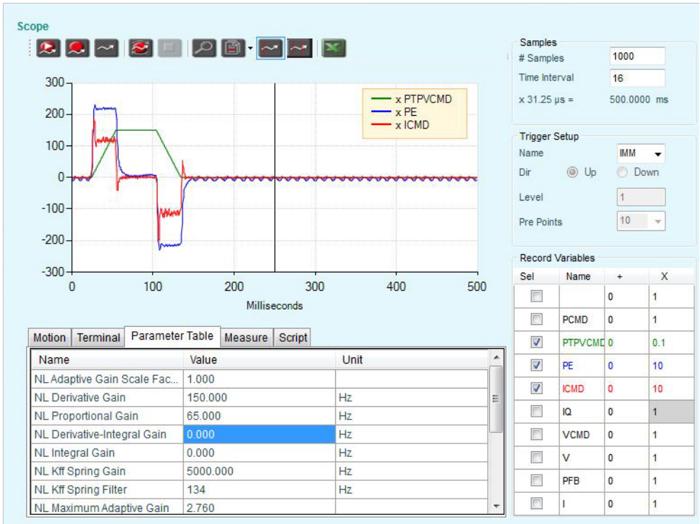
图 12-20. KNLP 65 Hz – 合适（位置误差数值已放大 10 倍）
