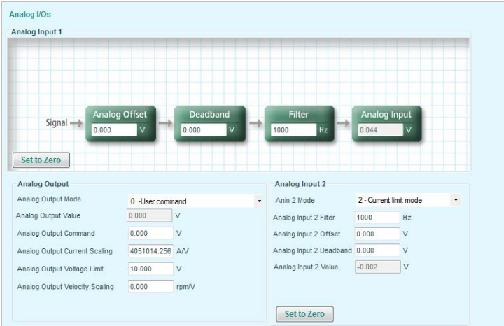
图 5-33. 第二模拟输入的限流功能
