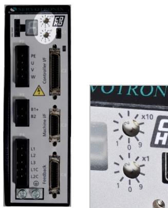
图 3-12. 驱动器地址设定旋钮
