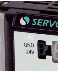
图 3-20. 24V 逻辑电源输入接口
