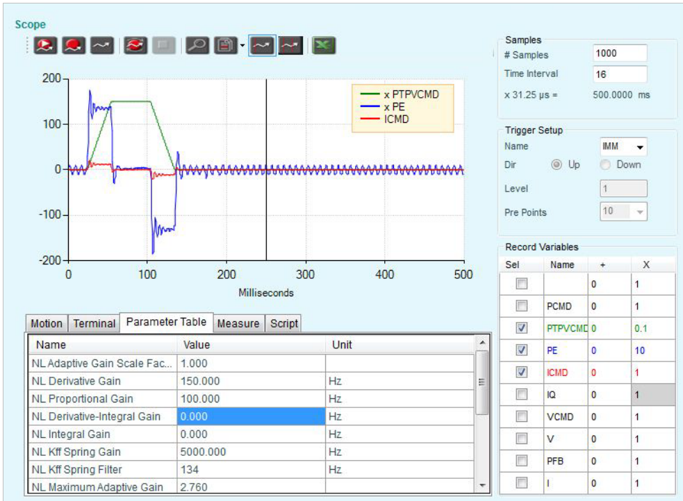
图 12-19. KNLP 100 Hz - 数值过大，位置误差在运动过程中出现超调，在结束时出现振荡
