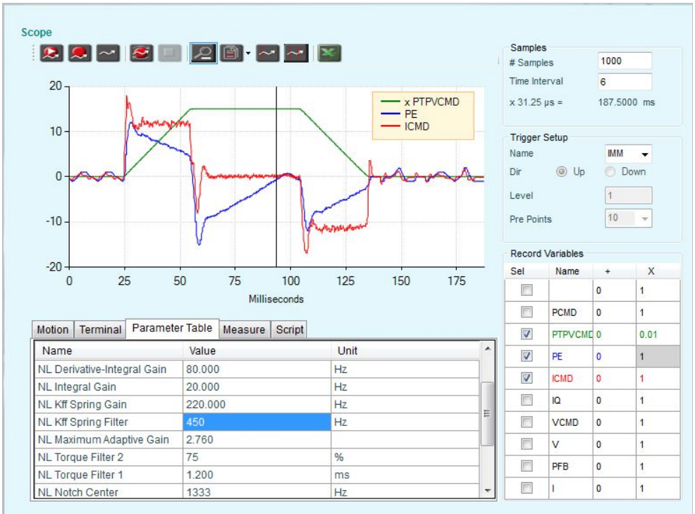
图 12-25. NLPEAFF 220 Hz – 位置误差的最大值减小，整定时间减小
