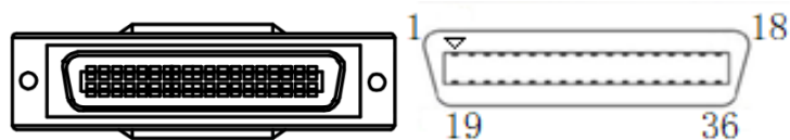
图 2.2.5.1 C2-控制器 I/O 外观及引脚序号
