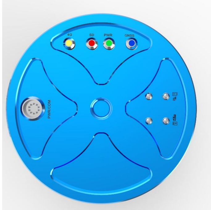
普适型 GNSS 接收机底部视图
