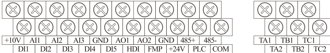
图 3-11 EM12 控制回路端子图
