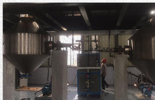
混料机导热油炉
