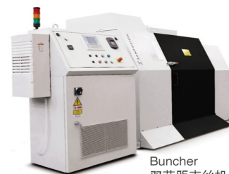
Buncher 双节距束丝机
