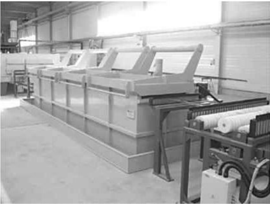
由 Sirio Wire 公司制造的超声波清洗装置
