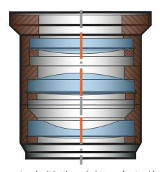
Linsenstapel mit justiergedrehten gefassten Linsen lens stack with alignment turned mounted lenses
