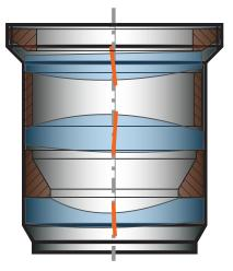
Herkömmlicher Aufbau als Linsenstapel conventional mounted lens stack
