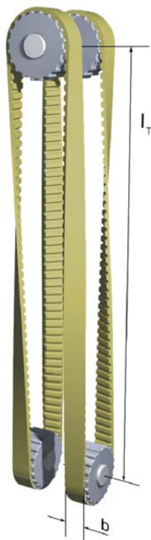
Winkeltrieb mit 2 Achsen
