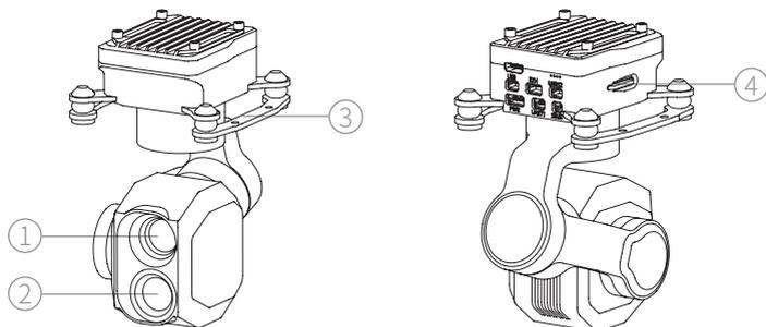
1. 热成像相机    2. 定焦相机    3. 减震平台    4. MicroSD 卡槽
