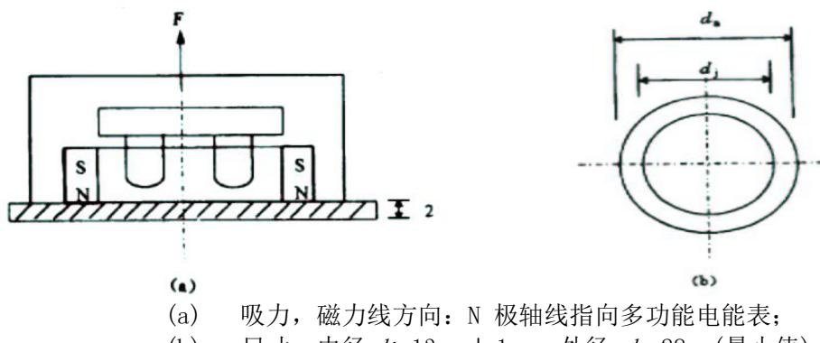
图2 磁钢的特性参数(单位: mm)
