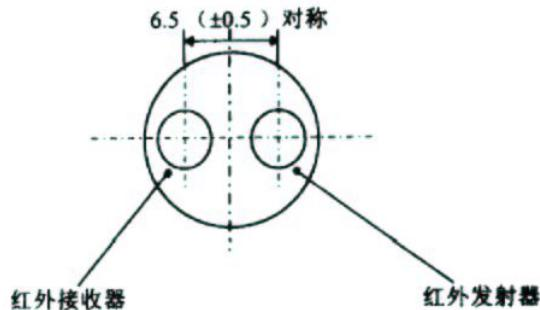
图 3 光口正视图(单位: mm)
