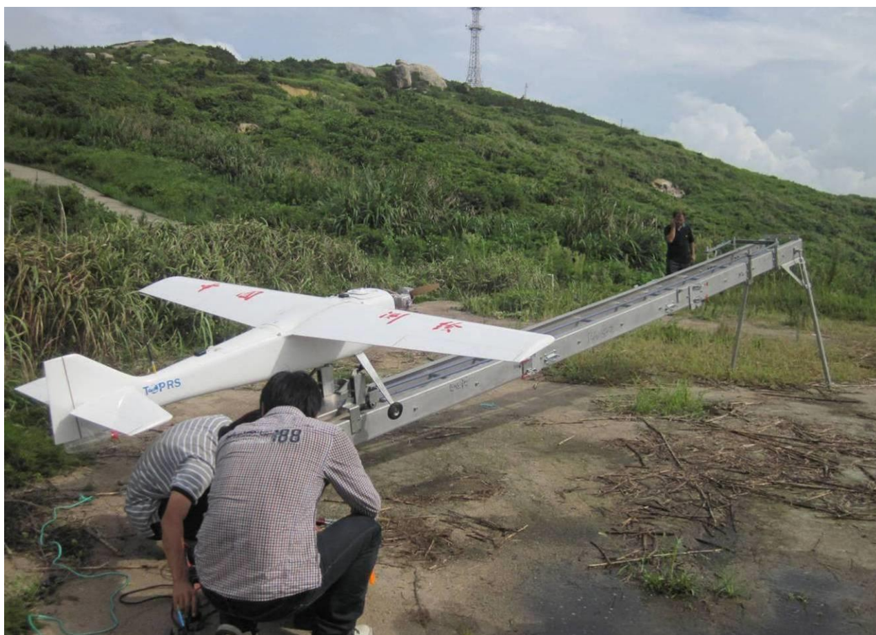
成功进行了适合海岛环境的弹射起飞和撞网回收试验
