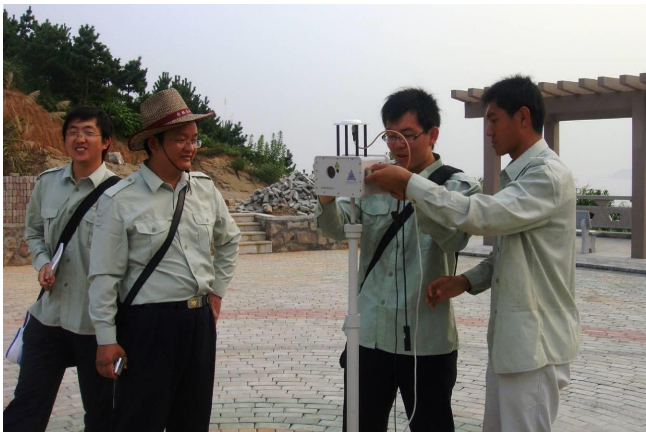
岛上实时定位精度 2~3 米，后处理定位精度分米级
