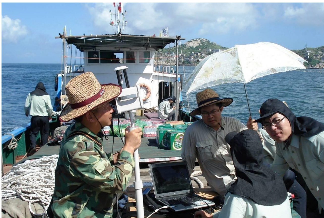
船上实时定位精度 5 米，后处理精度 0.5~2 米
