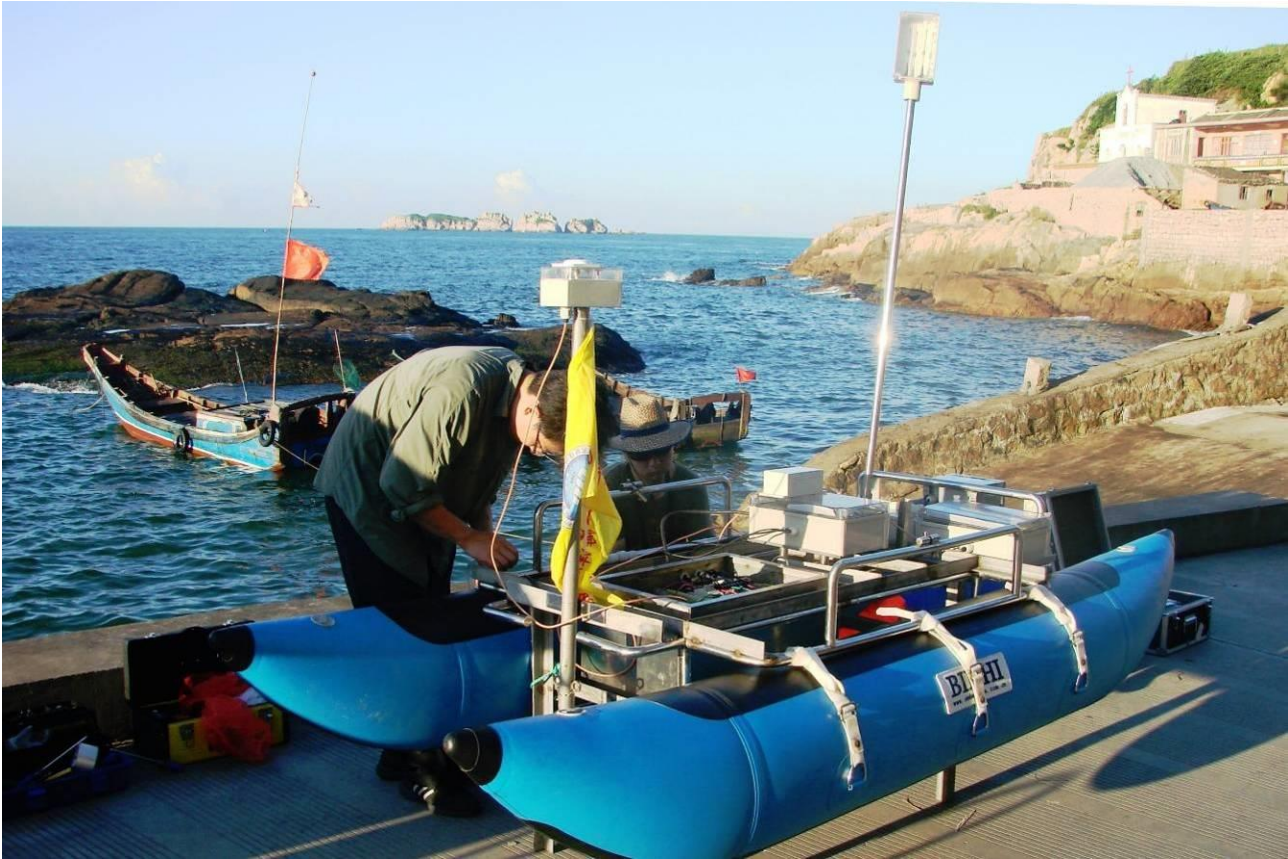
水深测量范围 0.5m~30m，测深精度 10cm，续航时间不小于 3 小时。
