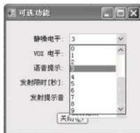
静噪设置可分为10级，对讲机默认设置为3级。静噪等级越高，静噪抑制能力越强，但是随着静噪等级的升高，对讲机的接收能力将会有所下降。如果您选择的静噪电平过高，则无法听到较弱的信号；如果您选择的静噪电平过低，则信号将出现在背景噪音中。请根据不同环境选择您所需要的静噪等级，使对讲机达到最佳的使用效果。
