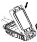
取下电池时，先把对讲机关闭，然后将对讲机背面顶部的闩锁向下推，使电池的顶端从对讲机中脱出，然后将电池取下。
