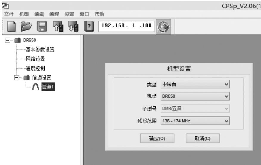
(4) 连接网络：点击软件界面最上面 IP 地址旁边的网络图标（地图形状）
