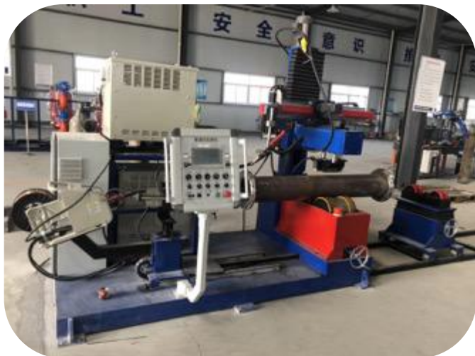
管道 法兰 自动 焊接
