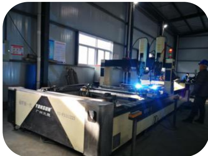
风管 法兰 自动 焊接
