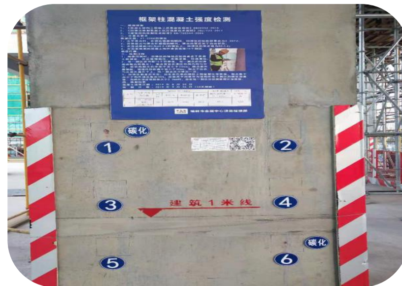
混凝土强度检测
