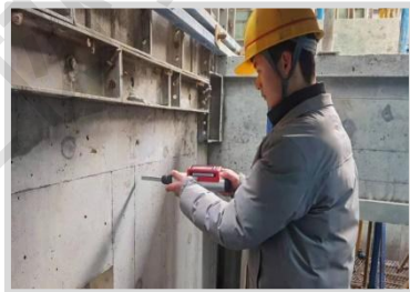
混凝土强度回弹检测
