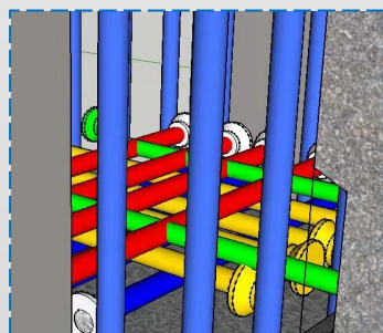
梁底主筋碰撞
