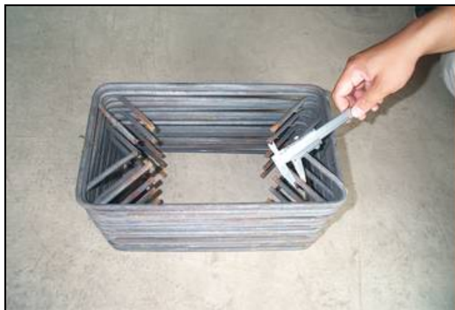
钢筋规格量测
