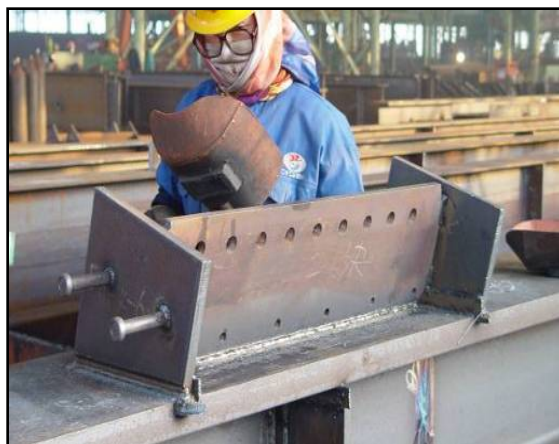
箱型柱埋弧焊
