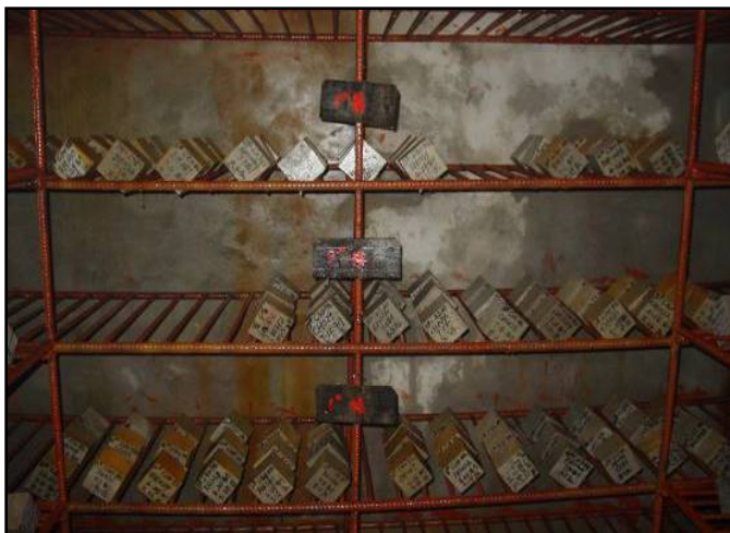
混凝土试块标准养护
