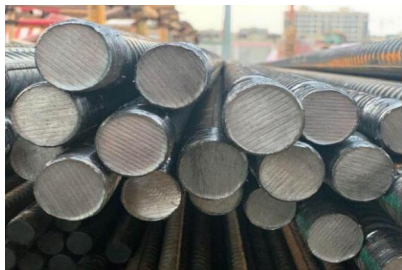
采用锯床进行钢筋切头
