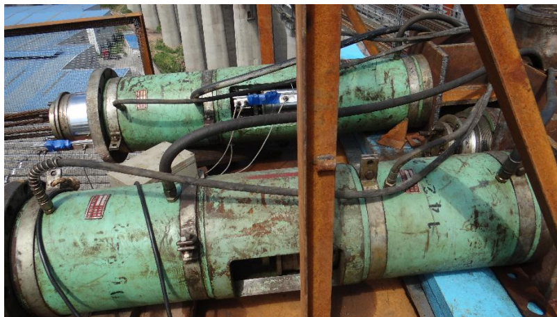
图 11-9 千斤顶安装示意图
