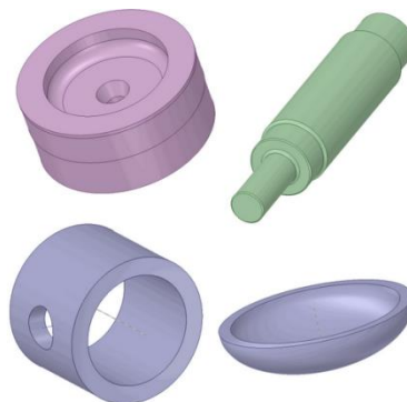
核反应堆用的自由锻件 — 液压缸封头、转子、套管、封头
