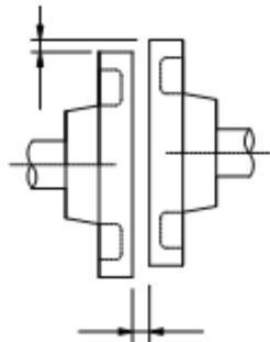
在一圈的四等分处进行测定，最大与最小的差小于 0.03mm。（与联轴器一起旋转）
