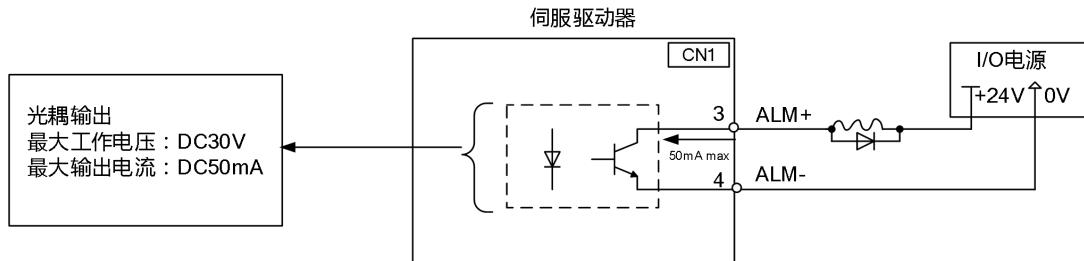
请在外部准备+24V 的 I/O 用电源，伺服驱动器内部没有提供+24V 电源。
