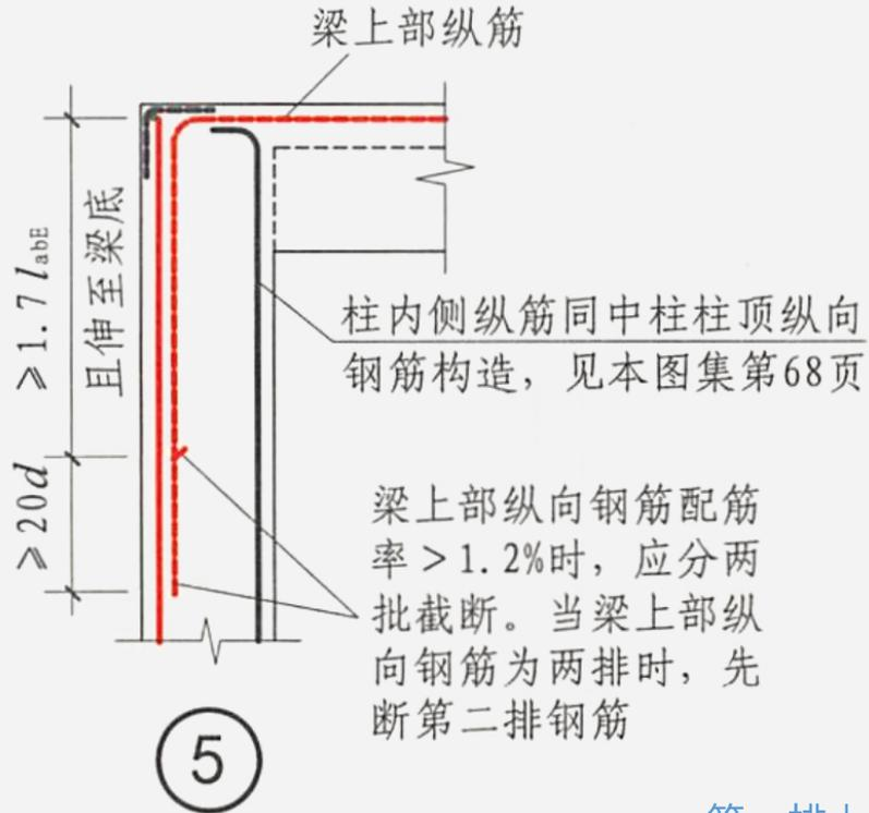
第一排上部钢筋弯钩长度  $\geq 1.7l_{abE}$  且伸至梁底  $\geq 20d$
