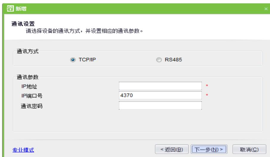
**IP 地址：**请填写门禁控制器的 IP 地址。
