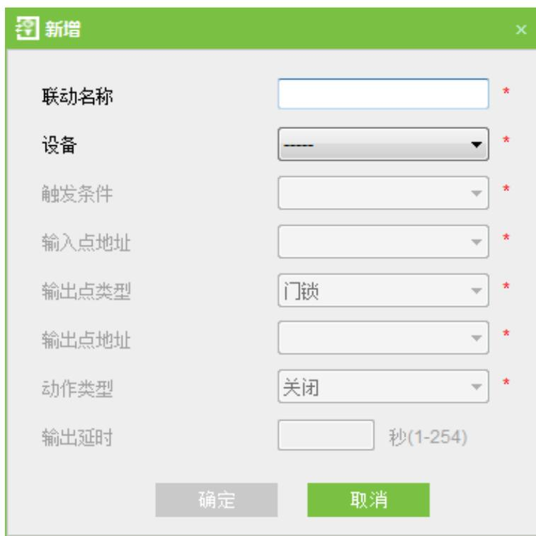
2. 输入联动设置名称（输入联动设置名称后才可以选择设备），选择设备后，会出现相应的联动设置界面（系统先判断该设备是否已经成功连接并且读取设备扩展参数，如辅助输入数量、辅助输出数量、门数量、读头数量等，如果系统中没有可用的设备扩展参数，将会提示用户无法进行联动设置。反之，将根据当前选中设备的门数量、辅助输入、输出数量，显示联动设置的选项）。
