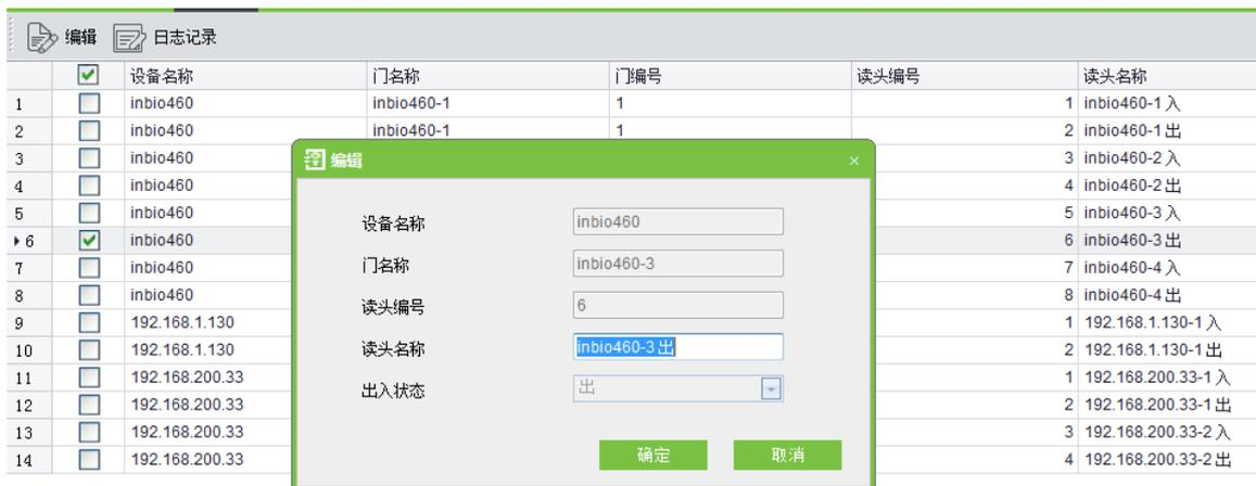
**备注：**脱机设备没有出入状态，所以不添加读头。单门控制器、两门控制器、四门控制器和门禁一体机设备会生成读头，一扇门生成两个读头，分别代表出和入两种状态；在报表和实时监控中，根据事件中的出入状态显示读头名称。
