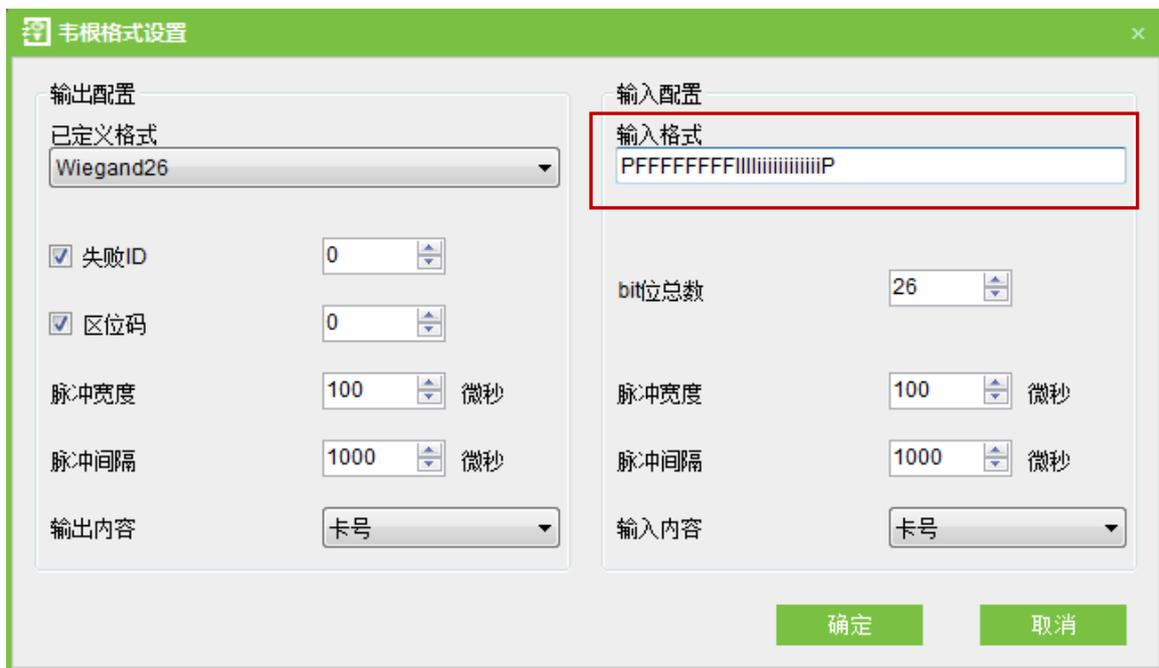
脱机设备黑白屏的 Wiegand 输入格式包含以下内容：**制造商代码**（OEM Code，Wiegand26 中一般不定义，在 Wiegand37 和 Wiegand34 中可见到），**区位码**（Site Code 或机器号 Facility Code），**用户编号**（ID Number），在格式中分别以其首字母（区分大小写）表示。小写字母表示**奇校验**（Odd），大写字母表示**偶校验**（Even），Oo 表示 OEM code，Ff 指 Facility Code，Ii 指 ID number，P 表示校验位。
