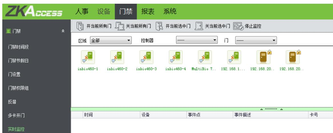
鼠标放在某扇门时，会显示相关参数：所属设备、IP 地址、门编号、门名称和状态描述，右击设备时，可以进行三个操作：远程开门、远程关门和取消报警。
