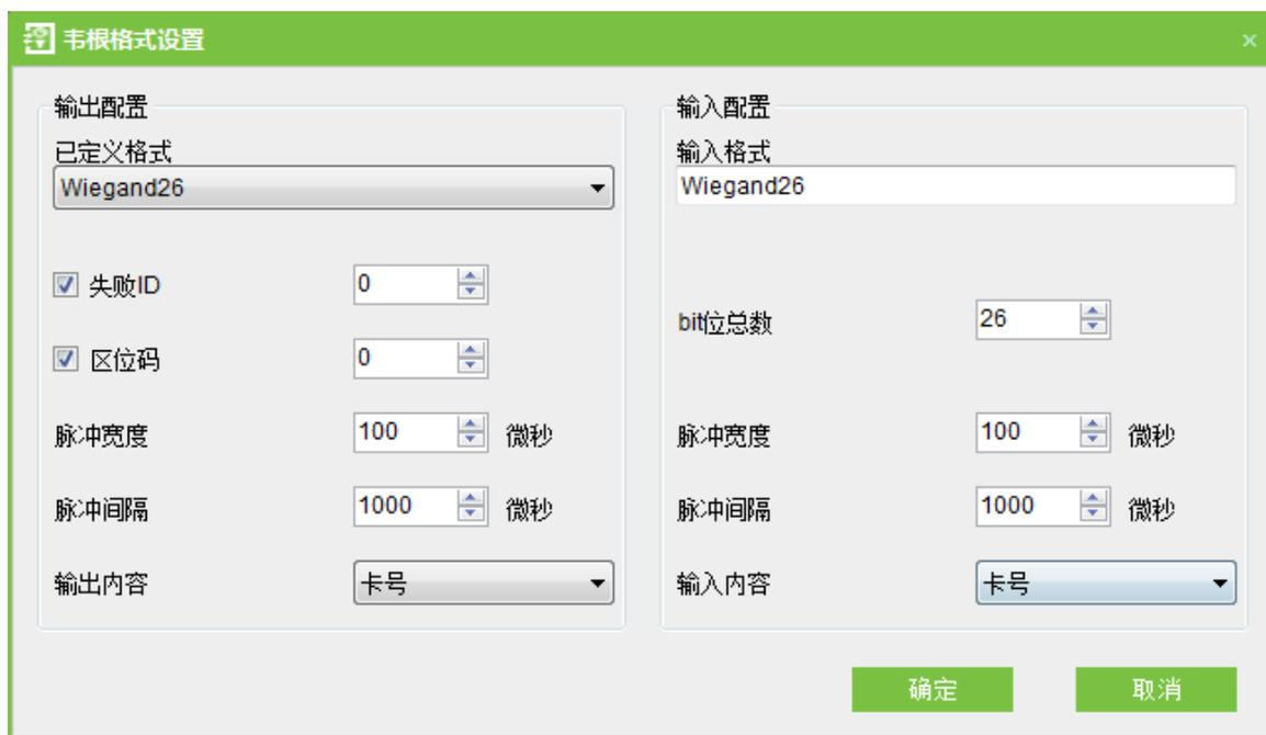
**Wiegand 格式：**系统内置韦根 26（有设备 ID）、韦根 34（有设备 ID）、韦根 26（无设备 ID）和韦根 34（无设备 ID），用户可根据需要选择。
