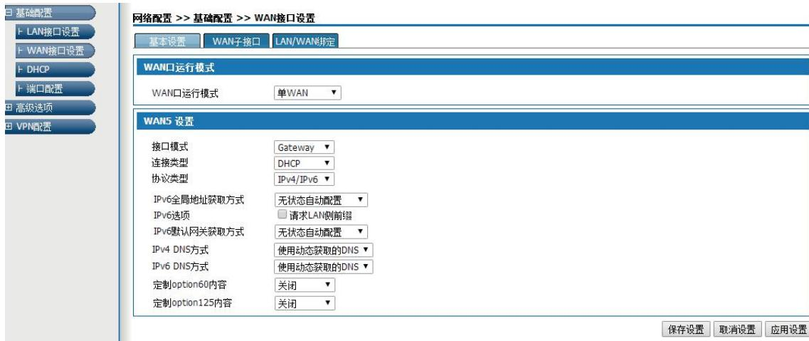
图 5-5DHCP 方式获取 IP 地址
