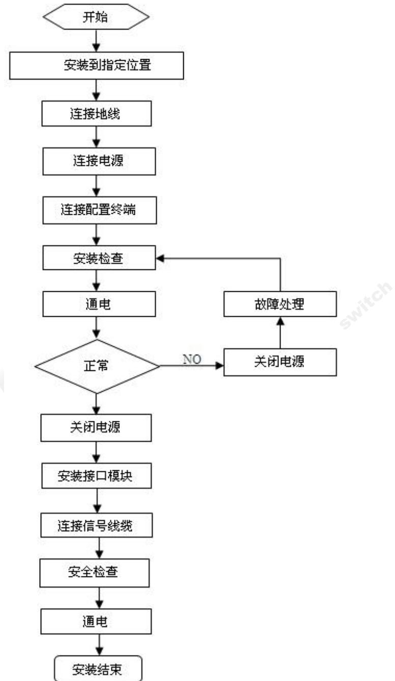
图 2-1 设备安装流程
