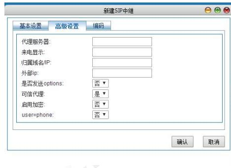
图 6-27a 新建 SIP-高级设置（适用于接口类型为 UNI）
