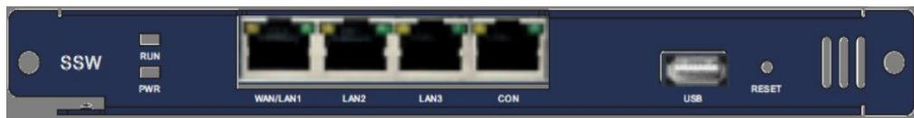
图 1-2 IAD SSW 系统交换板外观图
