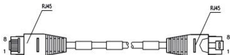
图 2-3 以太网电缆示意图
