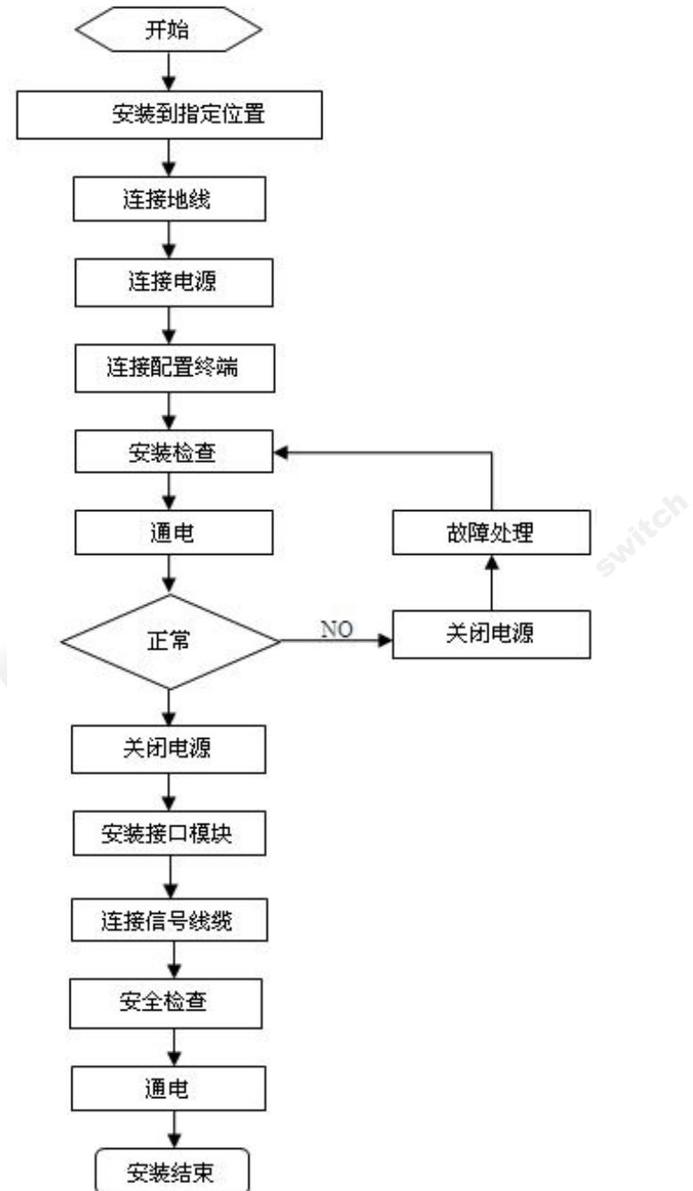
图 2-1 设备安装流程
