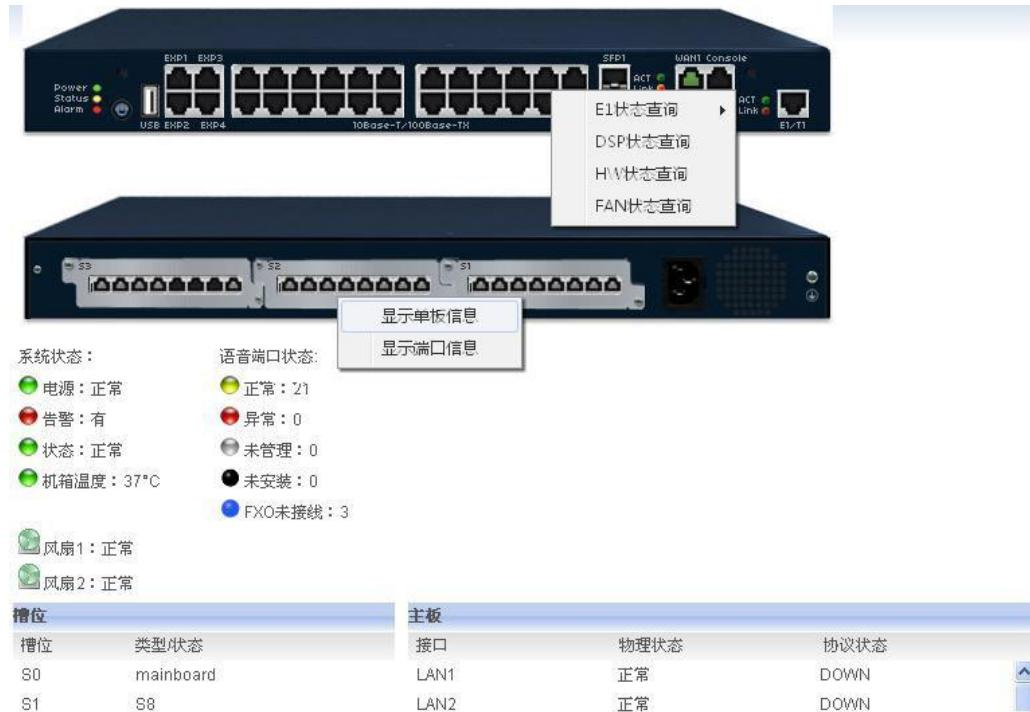
图 6-35 网元远程维护-设备面板
