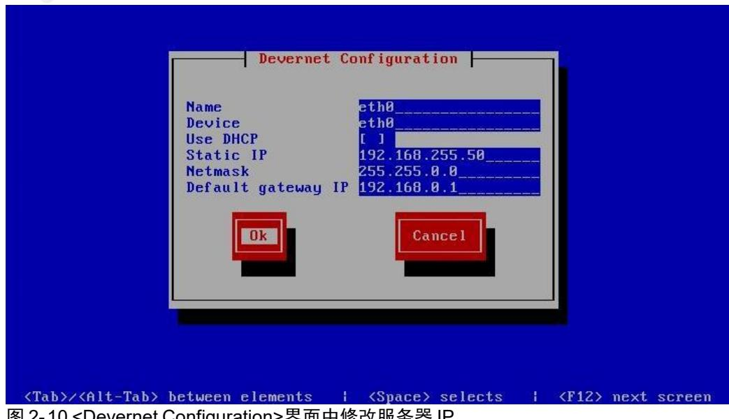
图 2-10 <Devernet Configuration>界面中修改服务器 IP
