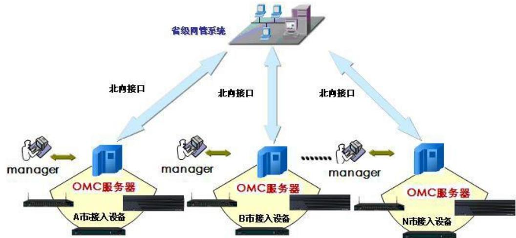
图 1-4 网管系统分布式部署图
