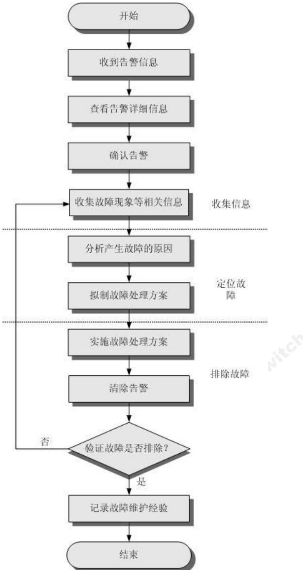
图 9-40 告警处理流程图
