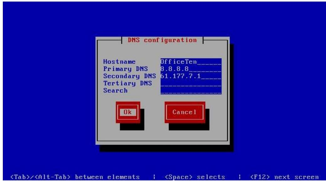
图 2-13 &lt;DNS configuration&gt;界面中修改 DNS 服务器
