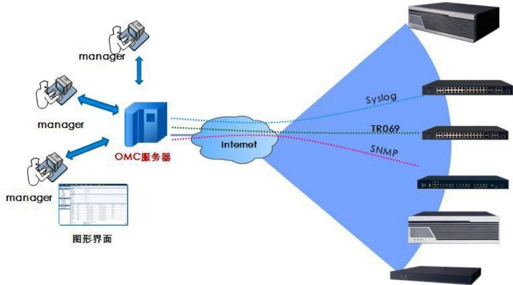
图 1-3 网管系统集中式部署图
