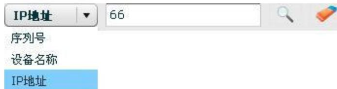
如上图所示搜索条件可选序列号、设备名称、IP 地址，在文本框输入搜索条件关键字，单击搜索按钮 ，弹出符合搜索条件的网元拓扑信息，单击清除按钮 ，清除搜索条件。
