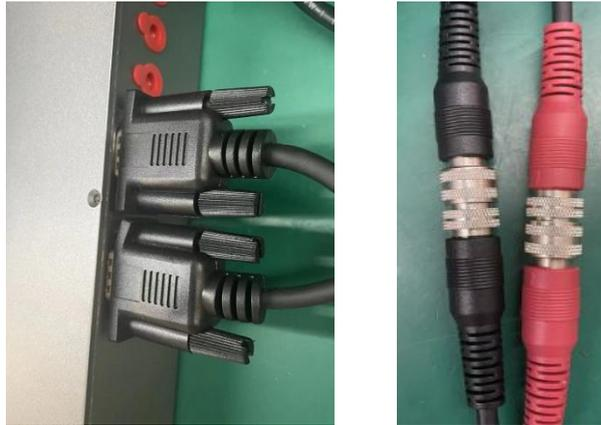
**注意：**新版控制线缆为一端 M12 的航空头（红色为动力线缆，黑色为信号线缆），另外一端为两个 DB9 接口。
