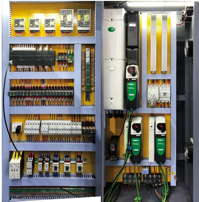
6. 电控部分:全部采用德国进口的西门子 PLC 及 CT 的驱动器控制系统,使操作更为简便、自动化,切断长度、数量及成品总数等,可直接在触摸屏里输入.实际切断长度及裁切数量可及时显示.高效节能的大功率 CT 伺服驱动螺旋刀轴,并配合储能柜,有效减少电能的损耗,提高了经济性,减少了生产成本。
