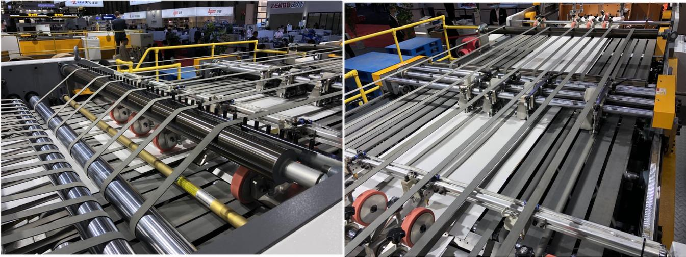
4. 设计合理的自动反曲装置，可以有效的去除纸卷的卷曲度，使纸张更为平坦，更有利于纸卷张力的稳定性。
