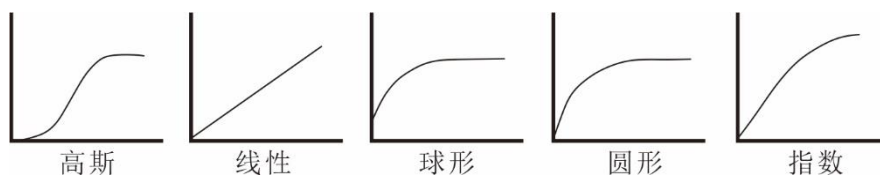
图 5-17 五种拟合半方差图的数学模型:高斯、线性、球形、圆形、指数
